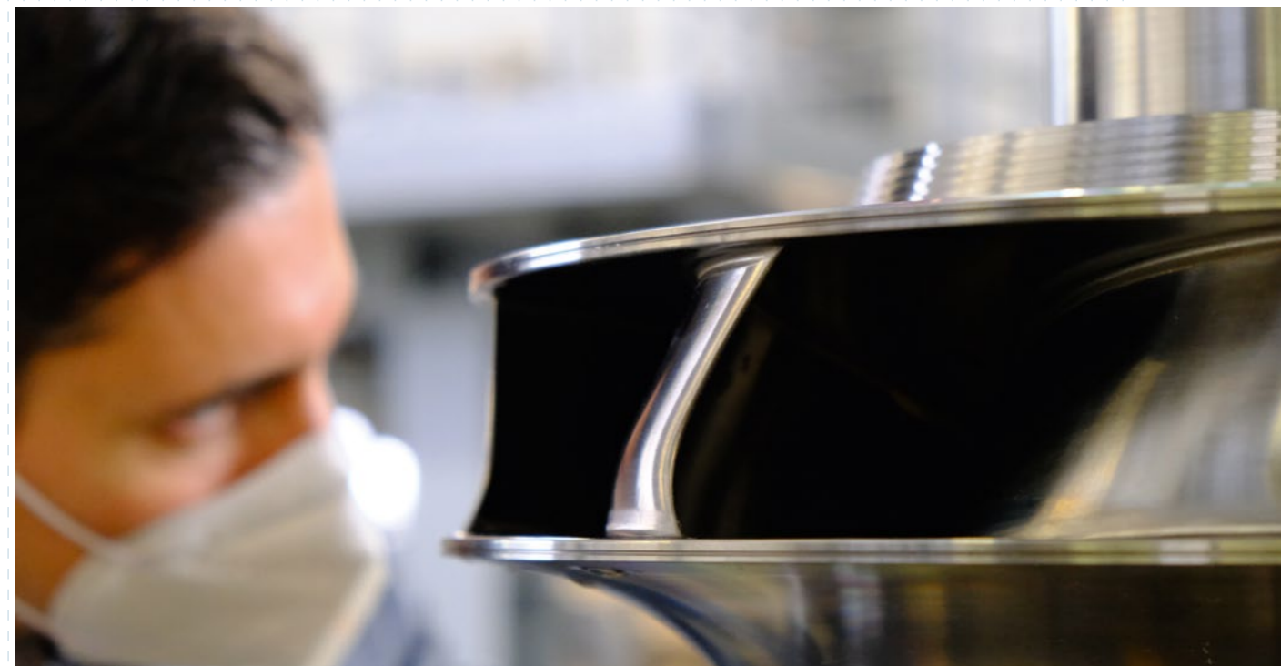
+ Modell im Maßstab 1:6,3 des Turbinenlaufrads für das Pumpspeicherkraftwerk Kühtai 2
